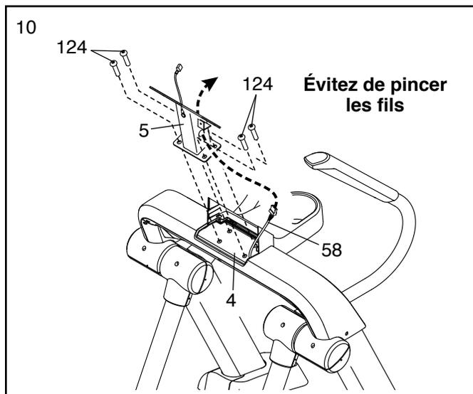
11. **Conseil : les connecteurs de fil doivent glisser facilement l'un dans l'autre et s'enclencher en place. Si ce n'est pas le cas, tournez un des connecteurs et essayez de nouveau.**
