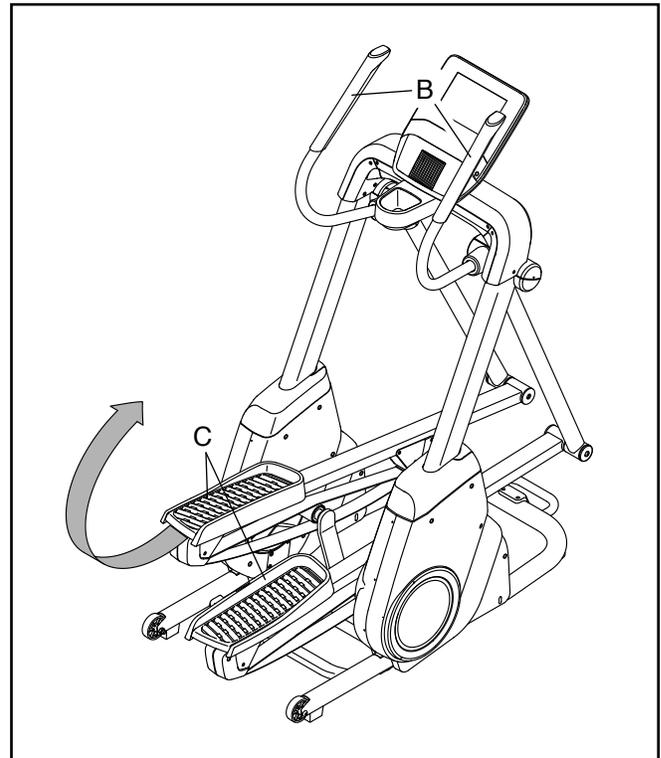
Pour descendre du vélo elliptique, attendez que les pédales (C) soient complètement immobiles. **Remarque : le vélo elliptique n'est pas équipé d'une roue libre ; les pédales continueront de tourner jusqu'à l'arrêt de la roue d'inertie.** Lorsque les pédales sont immobiles, descendez d'abord de la pédale la plus haute. Descendez ensuite de la pédale la plus basse.
