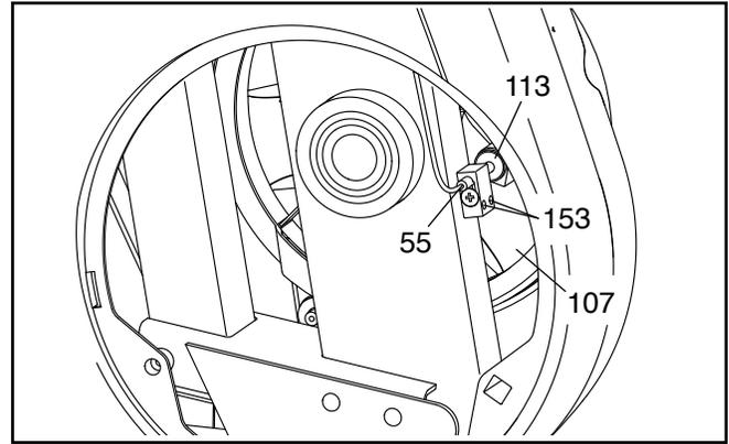
Ensuite, desserrez de quelques tours les deux Vis M4 x 25mm (153), puis faites glisser le Capteur Magnétique (55) légèrement plus près ou plus loin de l'Aimant (113).
