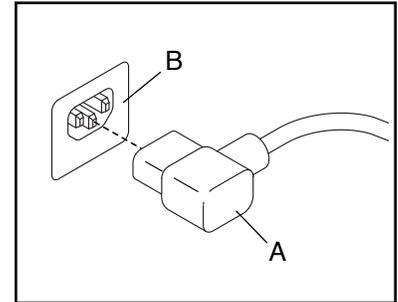
2. Branchez le cordon d'alimentation dans une prise de courant appropriée (C) qui est correctement installée et reliée à la terre conformément à tous les codes et règlements locaux.
