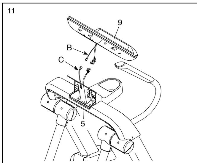
12. **Conseil : évitez de pincer les fils.** Fixez la Console (9) sur le Support de la Console (5) à l'aide de quatre Vis M4 x 16mm (141) ; **vissez chacune des Vis de quelques tours avant de les serrer complètement.**
